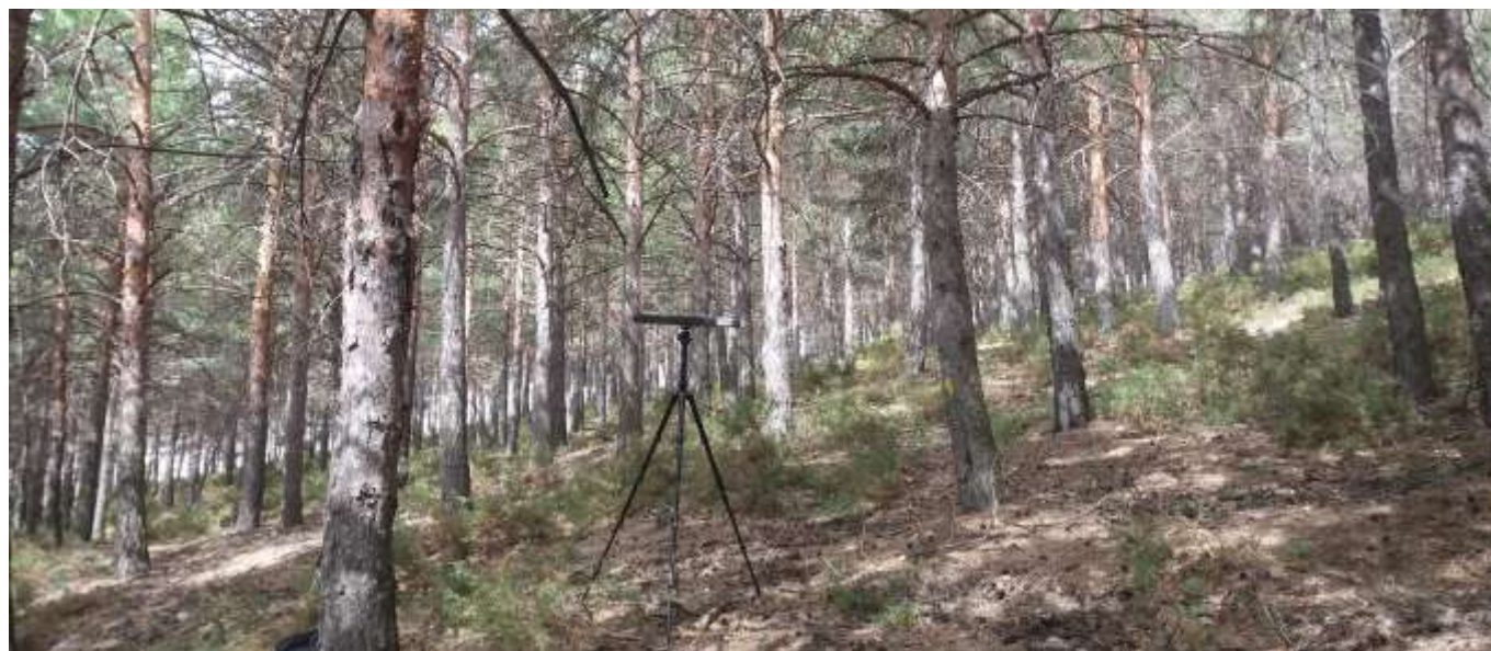
■ Sistema óptico para la captura de imágenes hemisféricas (Fotografía: J.M. Muñoz).
